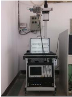
图1 Novocontrol Concept 72宽频介电和阻抗光谱仪测量 \kappa' 和 \kappa'' ,并利用最小二乘法,在2 450 Hz频率下获得其拟合曲线方程:
